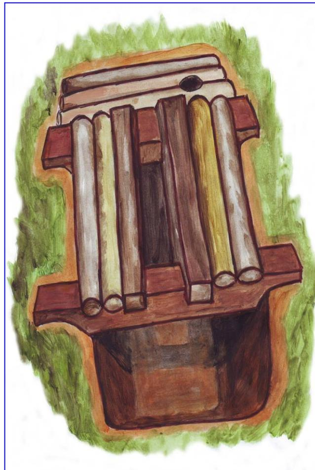
Poser deux bois carrés dans les encoches et compléter la dalle avec d'autres morceaux de bois en laissant un espace vide de 40 cm x 10 cm. Ne pas oublier de prévoir un trou pour la cheminée en bambou.
