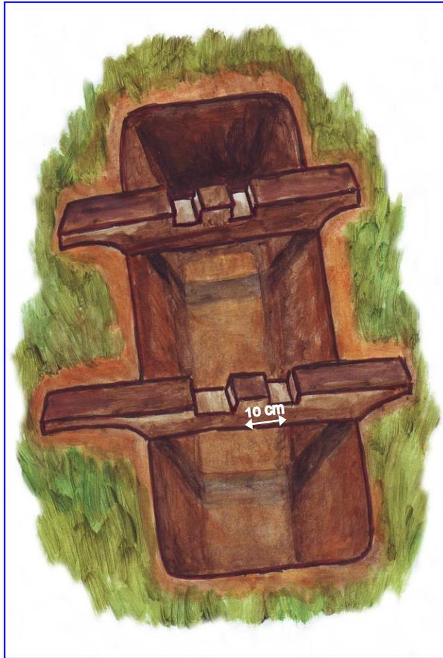
Creuser une fosse de 2 mètres de profondeur et 60 centimètres de largeur.
