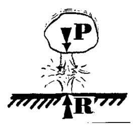
Le poids tend à écraser les matériaux, à les compresser. La qualité première des matériaux de construction est donc de résister à cette pression sans se déformer.
